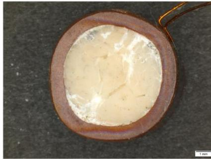
Figure 2-20 : Échantillon endommagé après chargement à rupture
