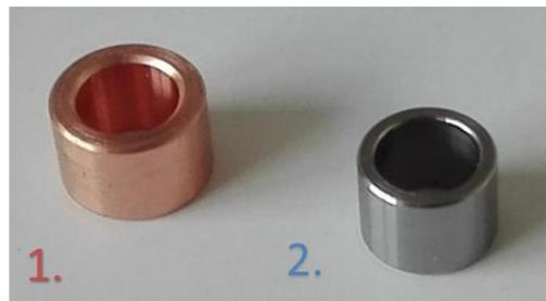
Figure 2-12 : Confinement utilisés lors des essais de compression.
