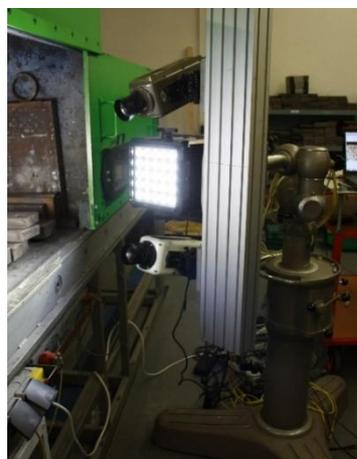
Figure 4-11 : Système d'acquisition de stéréo corrélation d'images.
