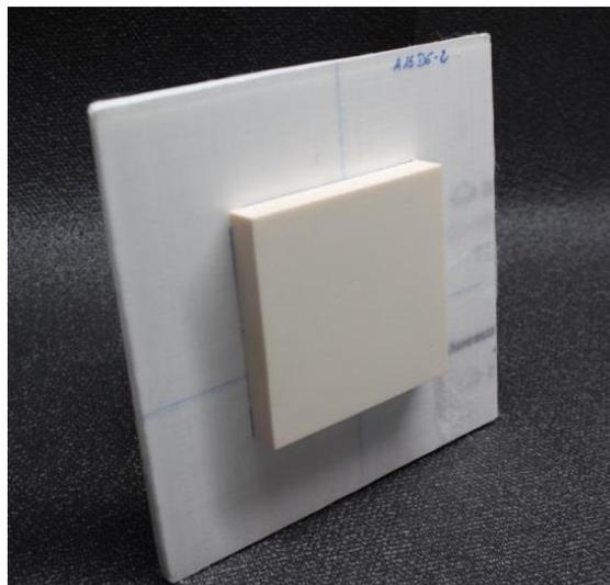
Figure 4-1 : Cible double dureté Alumine/Composite
