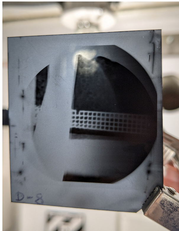
FIGURE 4.13 – Film radiochromique après une irradiation X sur l'installation OMEGA-60 pour une mesure de résolution sur cible.
