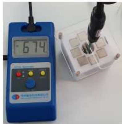
Figure 5: Image de l'aimant conçu avec son support PETG, et sa magnétisation en son centre mesuré par le magnétomètre WT10A.
