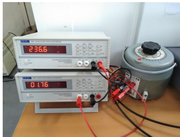
Figure 41 : Alimentation électrique de l'élément chauffant
