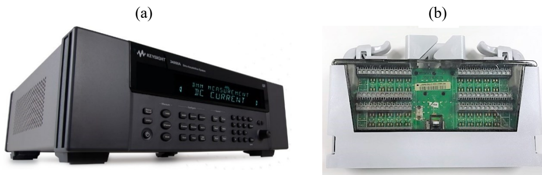
Figure 57 : (a) Centrale d'acquisition des données Agilent Technologies 34980A, (b) Multiplexeurs modèle 34921T
