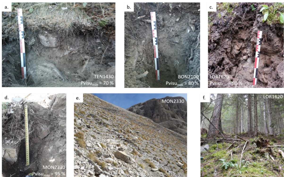
Figure 28 : Planche photo illustrant les quatre sols qui présentent les surestimations de stock de SOC les plus élevées. a. Hyperskeletal leptosol de TEN1430 dont l'estimation visuelle de la
