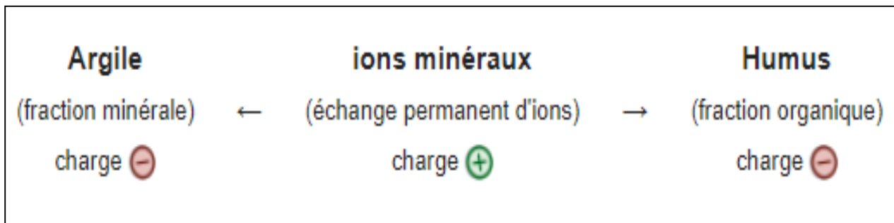
Figure 12: Adsorption des cations sur le complexe d'échange
