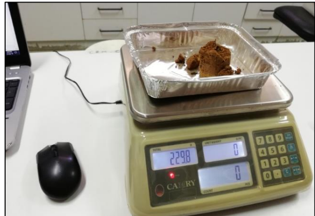
Photo 13: Mesure du poids des cylindres de sol
