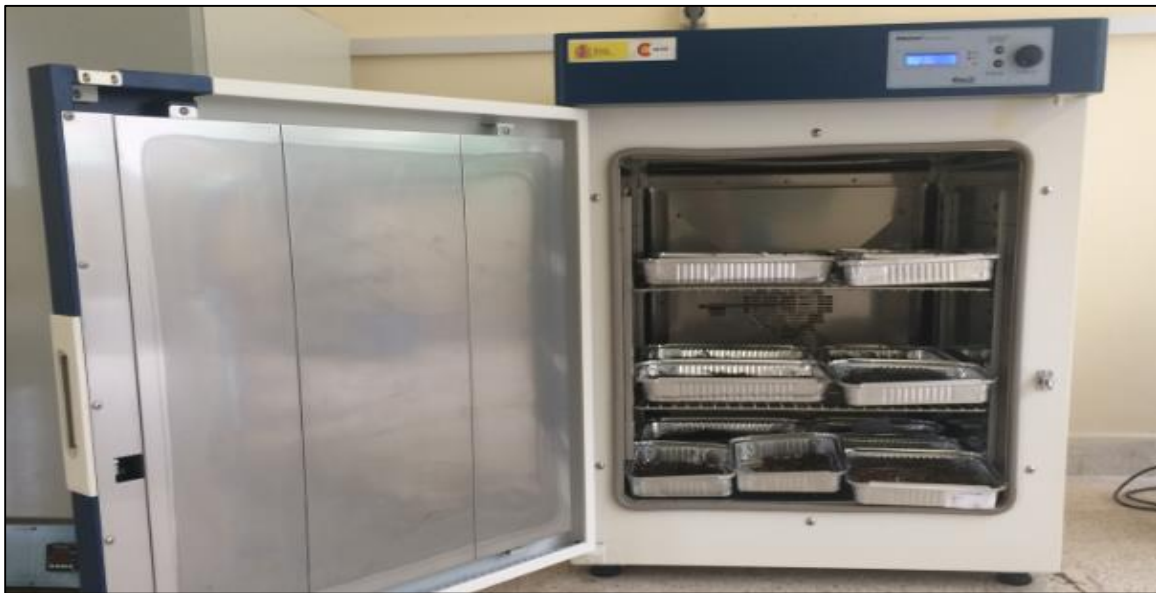
Photo 16: Séchage de la litière à l'étuve et Mesure de la partie aérienne des herbacées
