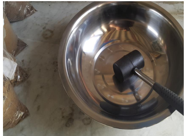
Photo 40: Broyage des échantillons de sol avant de les tamiser
