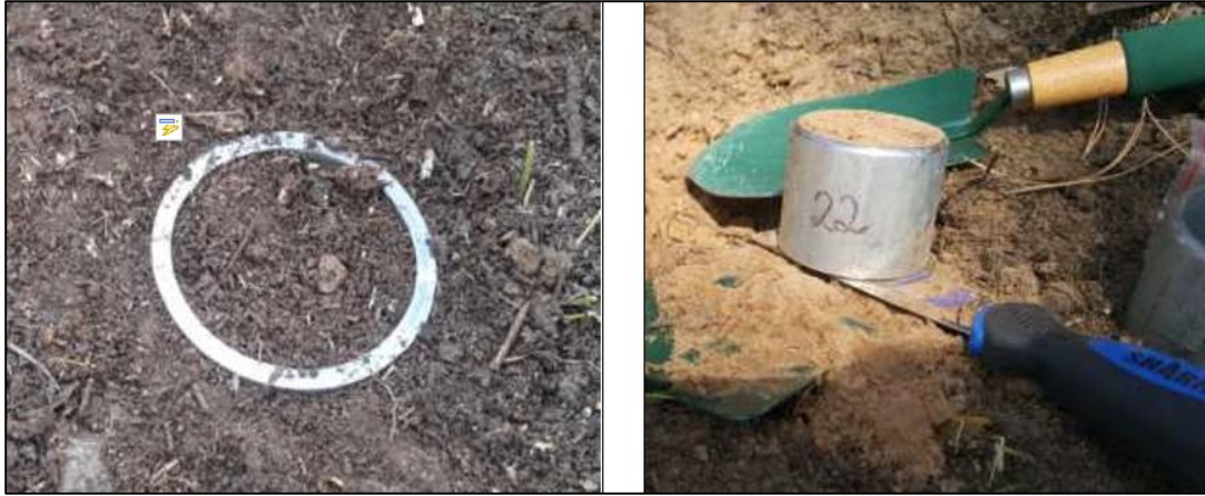
Photo 10: Echantillons de sol pour évaluer la densité
