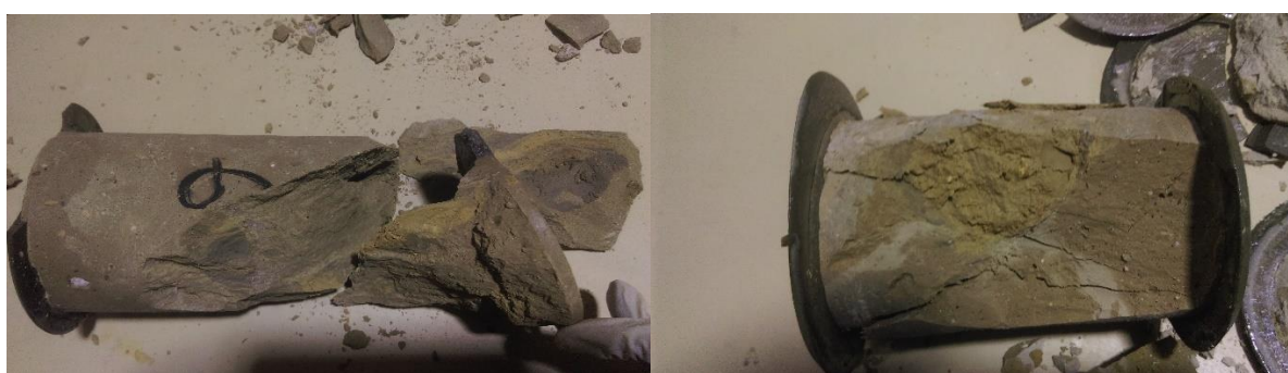
Figure III-6 : Echantillons D=10cm H=20cm situés à 2 m de profondeur dans la colonne I
