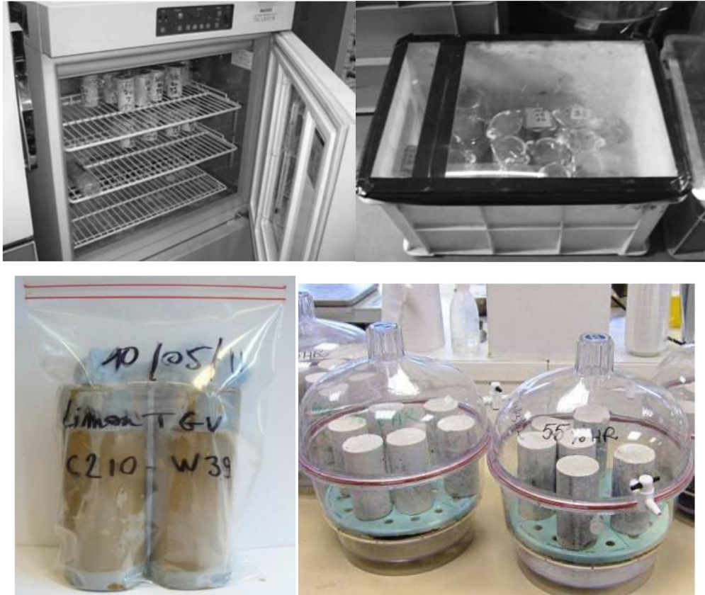
Figure I-25 : Méthodes de conservation en laboratoire : a) enceinte à température et humidité relative contrôlées, b) bac pour la conservation dans l'eau (Kitazume et Terashi 2013), c) conservation endogène, et d) solution saline (Szymkiewicz 2011), (Helson 2017)
