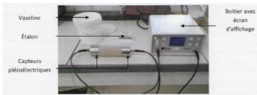
Figure II-18 : Dispositif expérimental pour la mesure du module d'élasticité dynamique : PUNDIT 7
