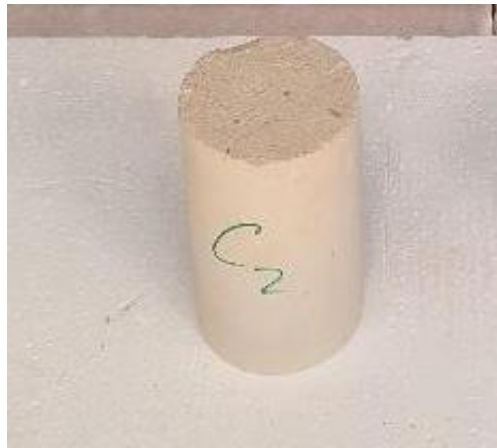
Figure VII-10 : Absence de fissures sur les échantillons S4C200W50 après un chauffage à 300°C
