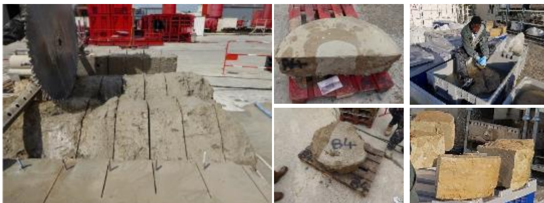
Figure II-4 : Découpage en tronçons, sciage en quarts de cylindre
