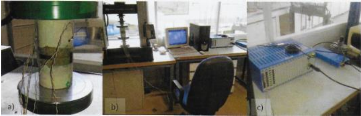
Figure II-17 : Dispositif expérimental pour la mesure du module d'élasticité : a) échantillon instrumenté avec jauges de déformation, b) poste de travail, c) système d'acquisition des données.
