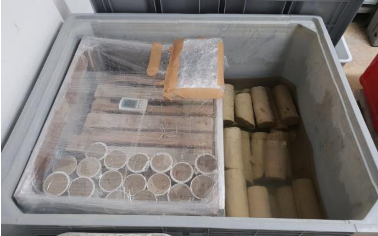
Figure II-20 : Dispositif permettant le maintien à une hygrométrie constante de 85%
