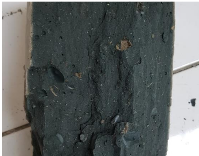
Figure III-17 : Photo montrant l'homogénéité d'un échantillon de dimension 11x22cm du CS_3 après un essai de compression à 60 jours de cure
