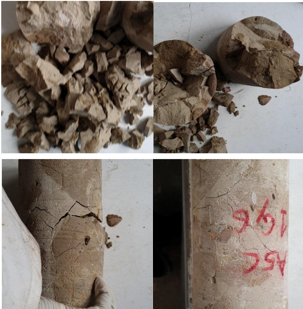
Figure VI-12 : Echantillons issus du chantier CS_1 après 6 cycles de gel/dégel : observations de fissures, émiettement de l'échantillons sous très faible sollicitation
