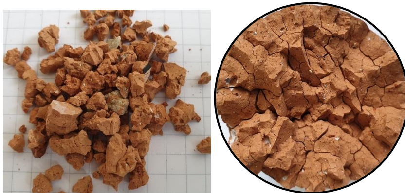
Figure VII-5 : Echantillon de béton de sol S2C200W50 après un chauffage à 600°C
