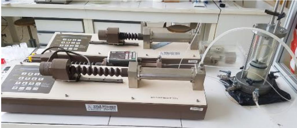
Figure II-14 : Dispositif expérimental pour la mesure de la conductivité hydraulique.
