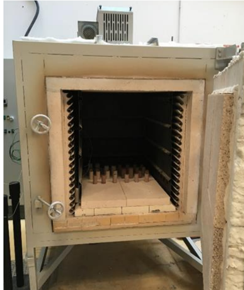
Figure II-22 : Four électrique Isartel et instrumentation
