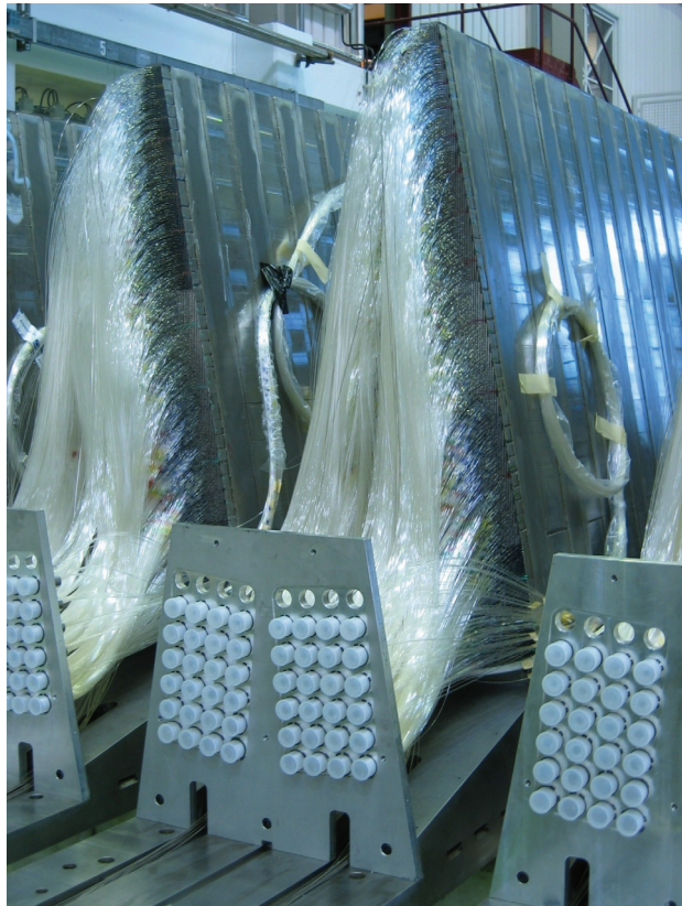
Figure 3.19: Assemblage du calorimètre “Hadron Forward” (HF) de CMS (39).
