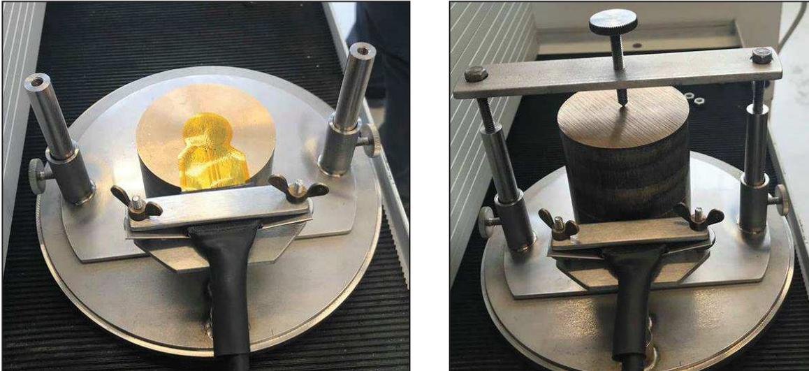
Figure I:3 : Utilisation du dispositif TPS pour un échantillon en Bronze
