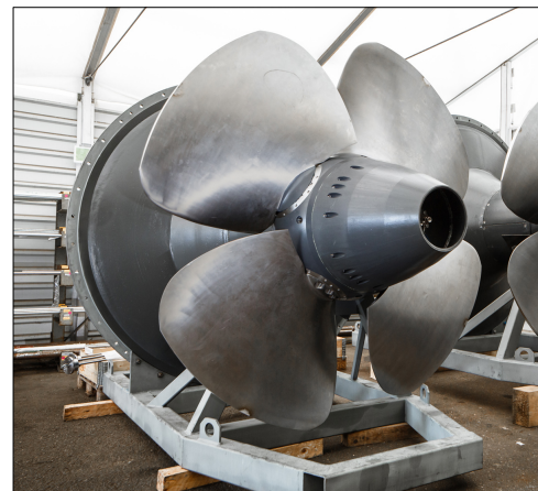
(b) Photographie d'une turbine Kaplan. Photographie Global Hydro Energy.
