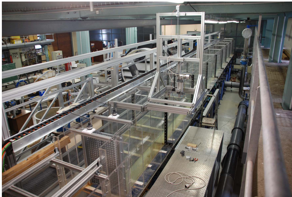
FIGURE 4.23 – Vue du canal à surface libre du site Rue Boussingault. Au centre, le support du cylindre oscillant.
