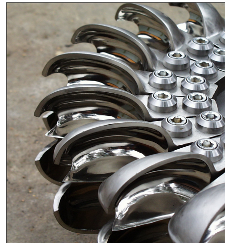
(b) Aubes, ou augets, de la turbine Pelton. Photographie Hydrohrom.
