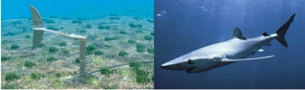
FIGURE 1.12 – Le récupérateur d’énergie bioSTREAM a été dessiné de sorte à reproduire le comportement hydrodynamique de la nageoire d’un requin.
