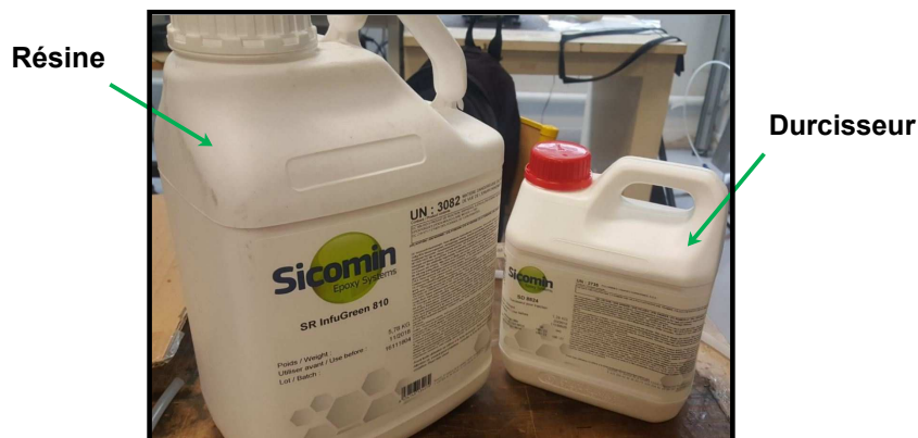
FIGURE II.5 – Résine et durcisseur bioépoxy InfuGreen 810 utilisés
