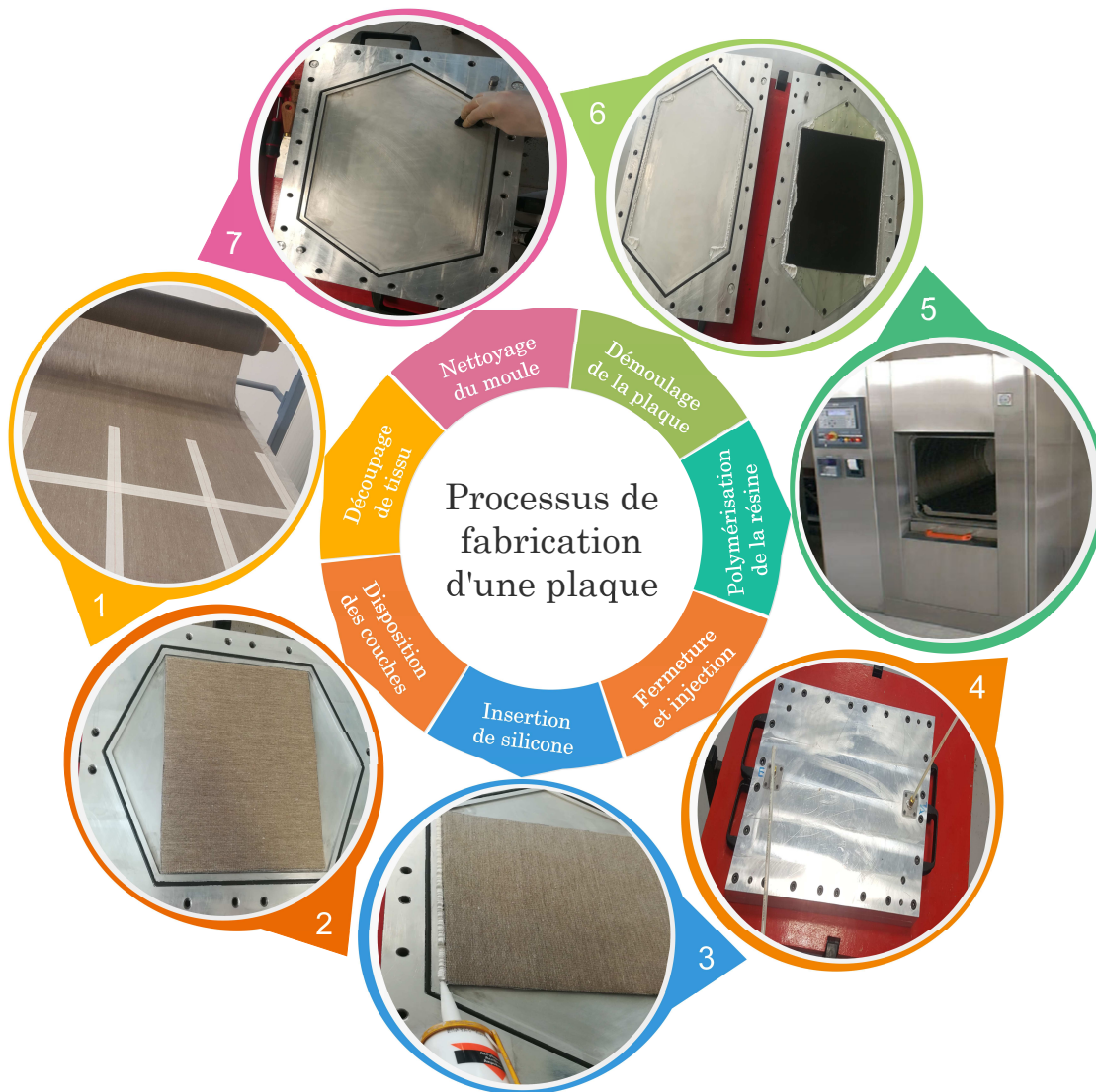
FIGURE II.10 – Processus de fabrication d'une plaque composite
