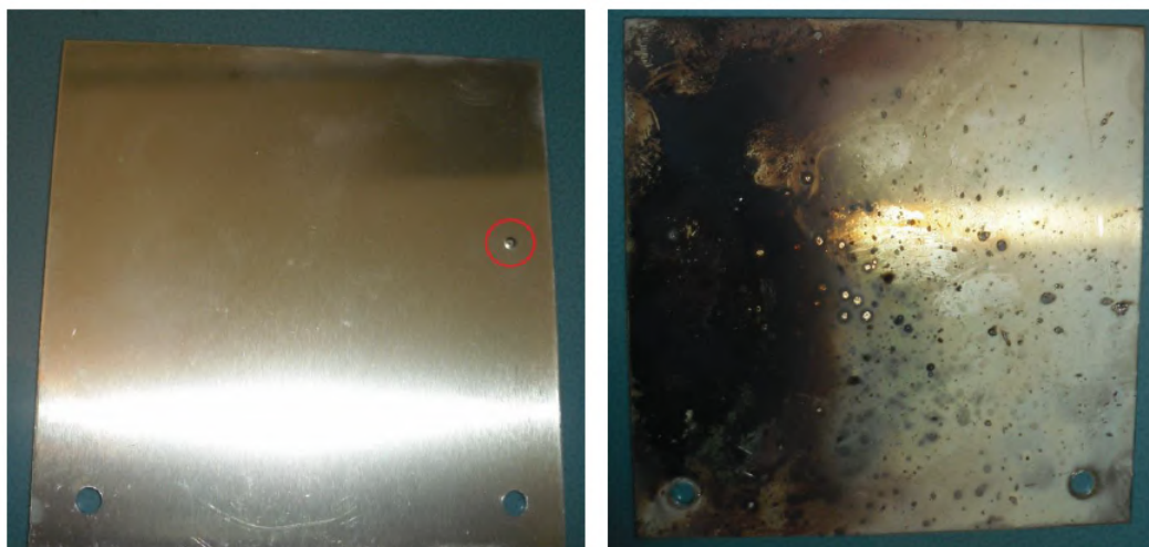
FIGURE 1.30 – Dégâts sur une plaque en aluminium (à gauche face arrière de la plaque, à droite face exposée à l’arc) [75].
