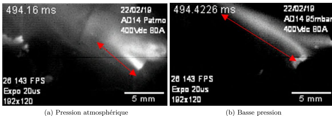
FIGURE 4.8 – Influence de la pression sur la longueur d’arc. Images extraites de l’acquisition vidéo à 26 143 i/s, temps d’exposition : 20 \mu s. Tension à vide entre les câbles 400 VDC, courant d’arc 80 A, câbles AD14 (aluminium). (a) Pression atmosphérique, (b) basse pression.
