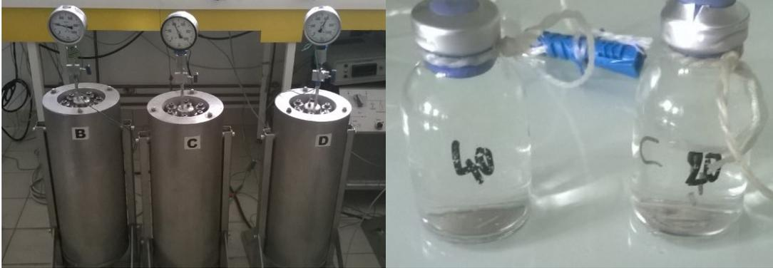
**Figure 46 :** Matériels utilisés pour les incubations hautes pressions/ hautes températures. À gauche, Incubateurs haute pression/haute température. À droite, des fioles Pénicillines dans lesquelles les cultures sous pression ont été réalisées.
