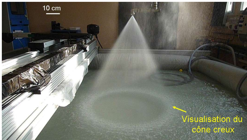
Figure 17 : Visualisation du jet conique creux Source : [18].
