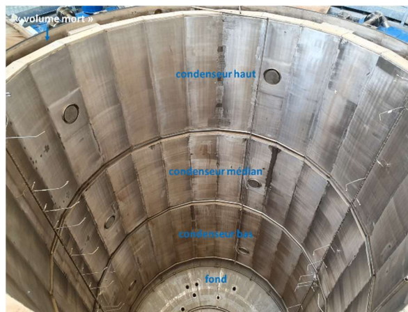
Figure 53 : Intérieur de l'enceinte MISTRA avec le positionnement des condenseurs. Source photo : CEA
