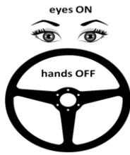
**Automatisation de niveau 3 :** dans certaines conditions de circulation, le véhicule est en conduite autonome mais le conducteur doit garder les yeux sur la route afin d'être en mesure de reprendre le contrôle à tout instant. Le conducteur n'est pas obligé de garder les mains sur le volant et les pieds sur les pédales si la réglementation locale le permet.
