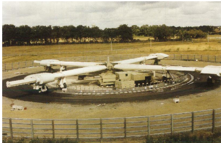
Figure P1-II.25 : Manège et dispositif de chauffage (Corté et al. 1989).
