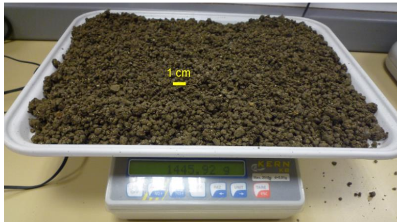
Figure IV.32 : Séchage du matériau.
