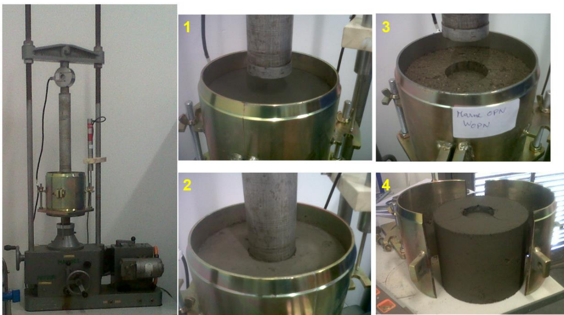
Figure IV.10 : Mesure de l'Indice portant Immédiat (IPI).
