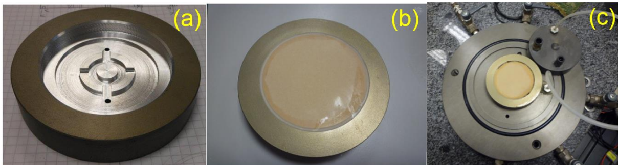
Figure I.16 : (a) Vue du réservoir avant le montage de la céramique, (b) céramique fixée sur la base triaxiale, (c) base triaxiale équipée de la céramique et montée dans la cellule triaxiale.
