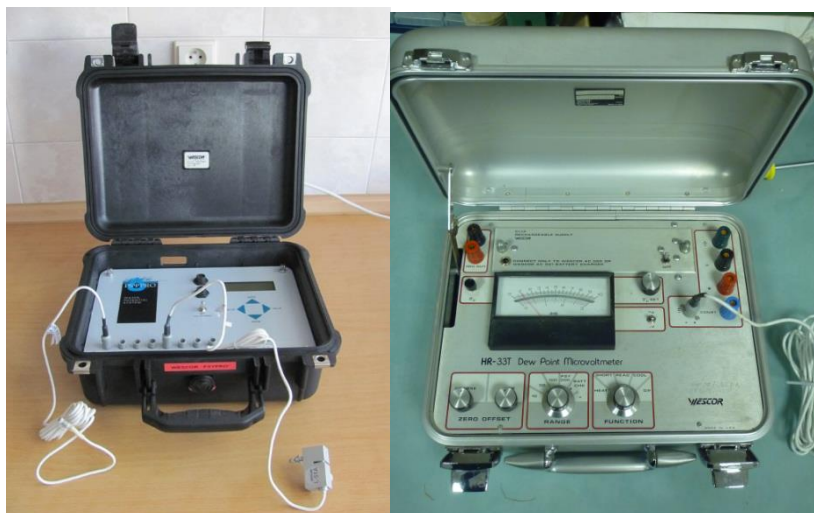
Figure I.14 : Centrales d'acquisition (automatique et manuelle).
