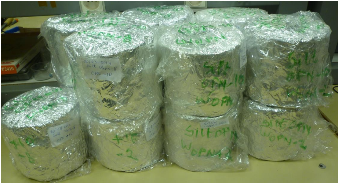
Figure IV.11 : Stockage des échantillons de sols compactés.
