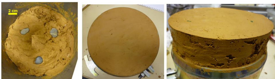
Figure VII.43: Argile à Châtaignier compactée avec des galets localisés.
