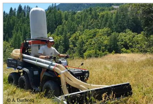
Fig. 2. Brosseuse avec aspirateur
