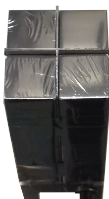
FIGURE 1.9 – Quartet de FAZIA dont les deux premiers étages de Si ont été démontés. Seuls les CsI sont apparents.
