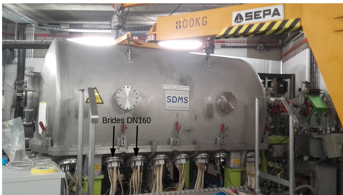
FIGURE 1.19 – Chambre à vide avec enceinte en place. Vue de profil avec les brides de sortie.
