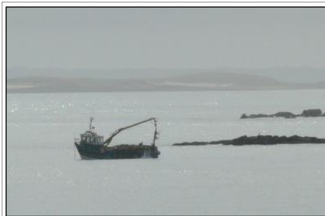
Figure 35 : Un goémonier de Lanildut, au travail dans l'archipel, visible depuis l'île de Molène. Il utilise le « scoubidou », bras se terminant par une vis, pour prélever les algues sur le fond.
