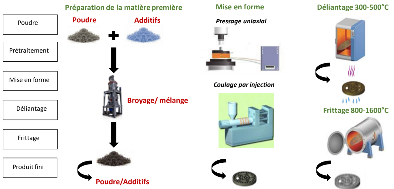
Figure 1- 2: Étapes d'élaboration des céramiques à partir d'une poudre
