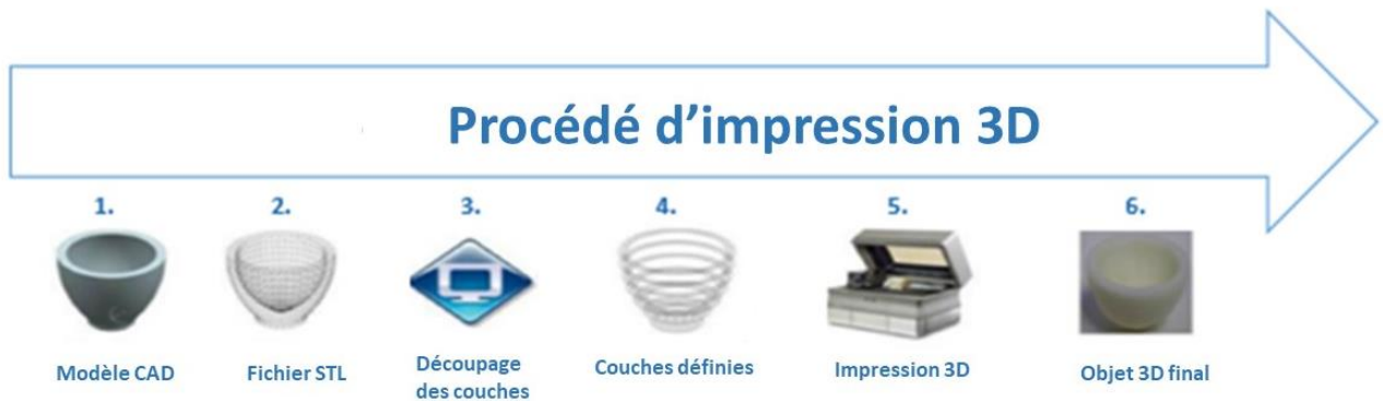
Figure 1- 14: Étapes du procédé d'impression 3D
