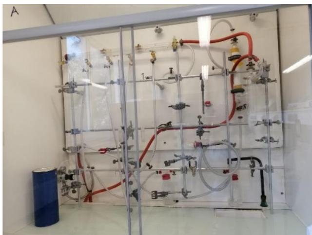
Figure 2- 6: Rampe mixte vide-argon installée sur une sorbonne équipée d'une hotte aspirante
