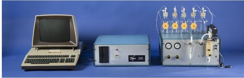
Figure I. 11: Photographie du premier synthétiseur d'ADN, modèle 280.
