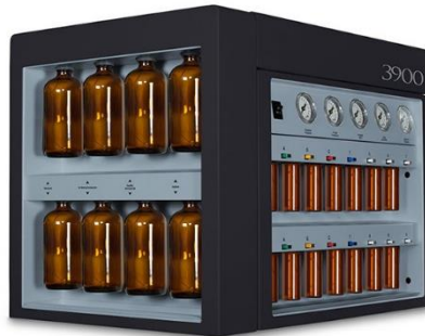
Figure I. 13: Photographie du synthétiseur Applied Biosystems, modèle 3900.
