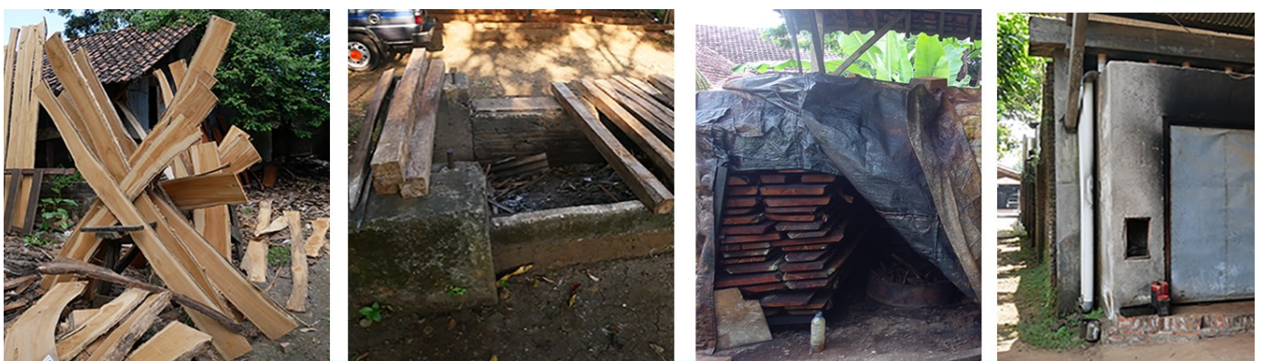
Photo 1: Eventail de dispositifs de séchage du bois (de gauche à droite) : claies (séchage solaire), four à ciel ouvert, four bâché, chambre de séchage
