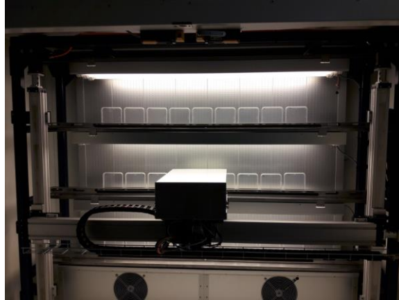
Figure 35 : Chambre ouverte de la Phénobox. La Phénobox permet de mesurer l'allongement de racines ou d'hypocotyles de 10 plantules par boîte, et peut contenir 27 boîtes verticales.
