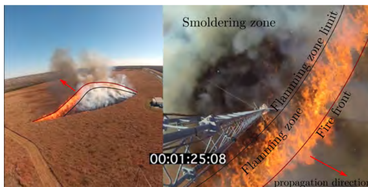
Figure I.13 – Extrait de la propagation du brûlage dirigé FIREFLUX II capturé par deux caméras. La ligne rouge foncée séparant la zone de flammes de la zone non-brûlée correspond au front de feu. La zone de flammes est comprise entre la ligne rouge foncée et la ligne grise. La flèche rouge représente la direction de propagation. Source : www.fireweather.org/fireflux2
