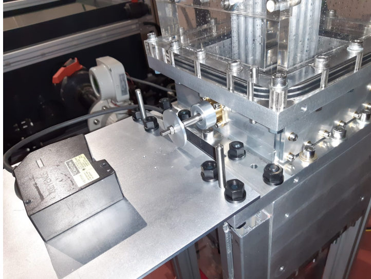
FIGURE 3.12 – Capteur de déplacement installé sur sa platine goupillée.
