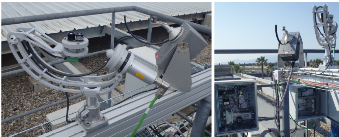
FIGURE 1.6 – Deux RSI installés au laboratoire PROMES-CNRS à Perpignan.
