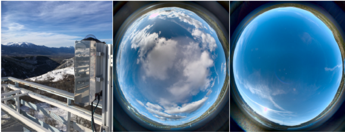
FIGURE 1.15 – PROMES sky imager installé sur le toit du grand four solaire à Font-Romeu-Odeillo-Via et quelques images HDR acquises.
