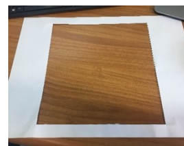
Figure 41 : Exemple de gabarit utilisé pour le prélèvement sur une surface plane (25 x 25 cm).
