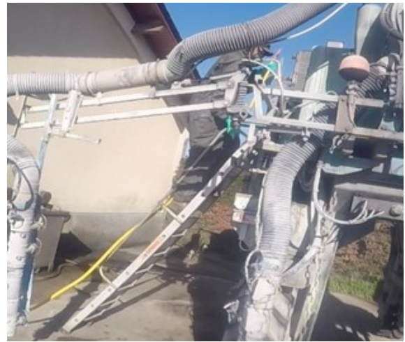
Illustration 90 : Remplissage cuve de rinçage avec tuyau.
