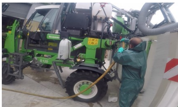
Illustration 26 : Raccordement du Top incorpo au pulvérisateur - directeur d'exploitation, 17 mai 2018.
