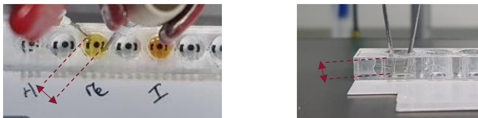
Figure 47: Mesure de la conductivité des ILs. A droite photo prise du dessus. A gauche prise de face.
