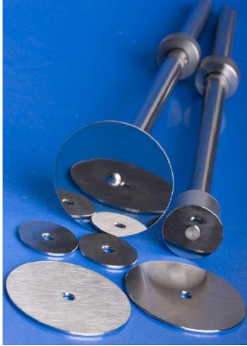
Figure II.10 : Dispositif utilisé pour les mesures du frottement poudre-paroi dans le rhéomètre FT4
