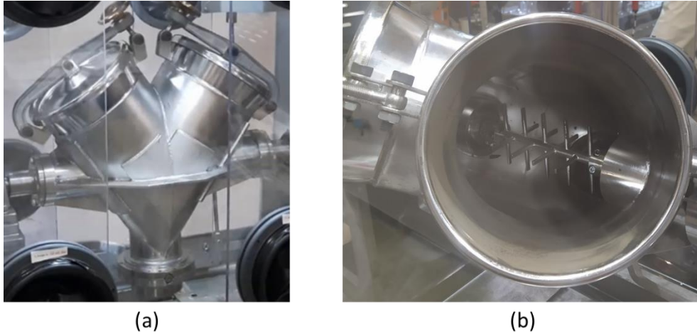
Figure I.29 : Image du mélangeur en V du DEC/SA3E placé en BâG (a) et de sa turbine située le long de son axe de rotation (b)
