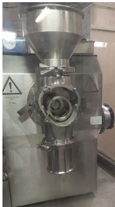
Figure I.30 : Image de l'OscilloWitt-Lab (de la marque Frewitt) du DEC/SA3E placé en BâG
