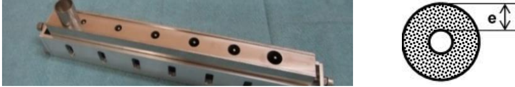
Figure II.9 : Photographie de la réglette perforée en géométrie annulaire
