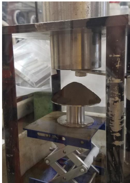
Figure II.15 : Dispositif mis en place pour réaliser les mesures de l'angle de repos
