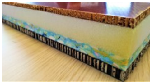
Figure E.2: Structure multicouche avec matériaux composites et mousses poro-élastiques.
