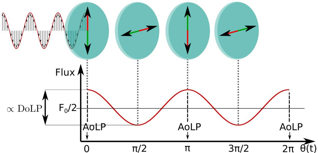
FIGURE 2.3 – Représentation du flux mesuré par *Petit Cru* pendant une rotation du polariseur. Le filtre polarisant est dessiné pour chaque extrémum du signal avec son orientation  $\theta(t)$ . Dans cet exemple, la lumière incidente est polarisée avec un *AoLP* de  $0^\circ + k\pi$ . Le flux total initial  $F_0$  se retrouve à partir de la moyenne du signal. L'amplitude des oscillations permet de remonter au *DoLP* initial et la position des maxima à l'*AoLP*.
