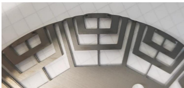
Figure 3.43 Déformation des ponts de fer
