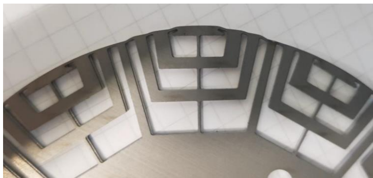
Figure 3.43 Déformation des ponts de fer
