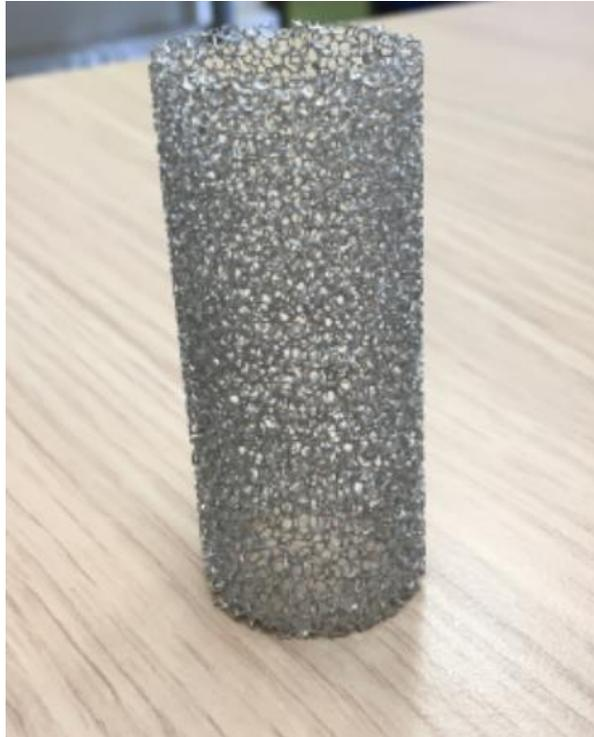
Figure 80: Mousse métallique en tube
