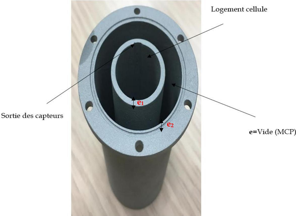
Figure 76: Moule en aluminium utilisé dans le cadre de cette étude
