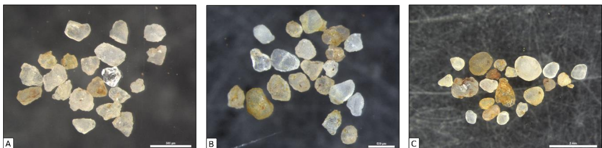
Figure 63: échantillons T7 de Tomboura I mettant en lumière le façonnement préférentiel des grains selon leur taille
