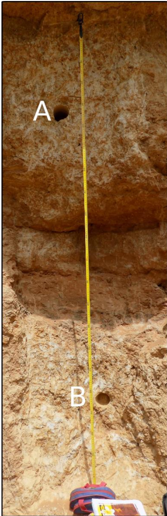
Figure 56: exemple de localisation des trous de la sonde permettant la mesure de la dose équivalente pour les échantillons de la coupe CP6 du ravin de Sansandé
