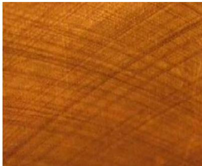
Figure 1.6 : Chemise de moteur obtenue par rodage classique [14]
