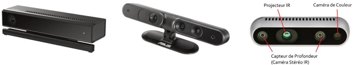
FIGURE 2.3 – Exemples de caméras RGB-D, de gauche à droite : Kinect V2, Asus Xtion Pro Live et Intel RealSense D435.
