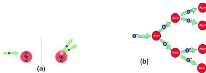
Figure 2.I.2 : Mécanisme d'ionisation dans un plasma: (a) génération d'un ion et (b) Ionisation en cascade.
