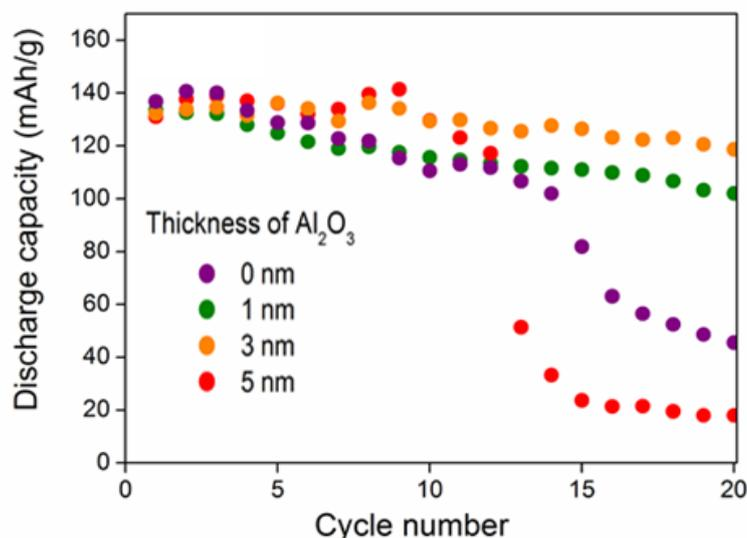
Figure 1.9 a-b Rétention de la capacité des électrodes LFP revêtues d'alumine à l'aide du dépôt par couche atomique (ALD) avec différentes épaisseurs de revêtement.
