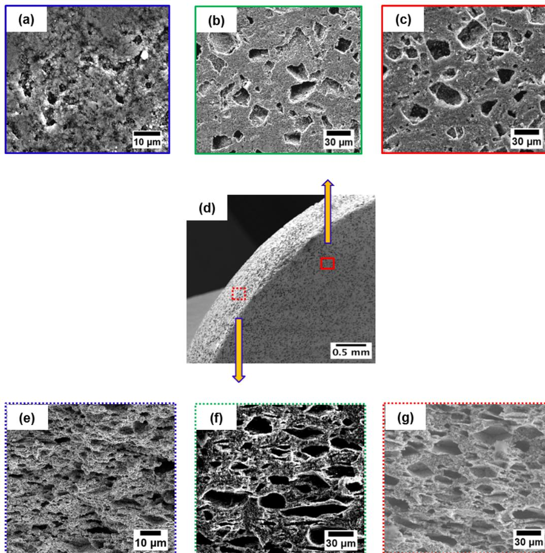
**Figure 1.6** Images MEB d'électrodes poreuses LFP contenant les pores créés par la dissolution du NaCl. (a, b, c) vue de la surface supérieure des électrodes montrant la forme cubique des cristaux avec les tailles correspondantes des cristaux utilisés, (e, f, g) Coupe transversale des électrodes LFP épaisses montrant la forme des pores alignés perpendiculairement au z -direction en raison de la pression uni-axiale du fonctionnement de SPS.
