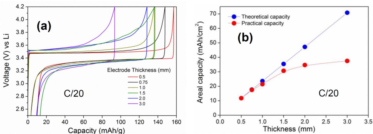
**Figure 1.8 Performances électrochimiques en fonction de l'épaisseur de l'électrode au taux C/20: a) Profil de décharge-charge du second cycle pour six épaisseurs différentes d'électrodes LFP vs Li, b) Capacité théorique vs pratique montrant une utilisation de matériau moins active pour une électrode LFP de 3mm d'épaisseur.**
