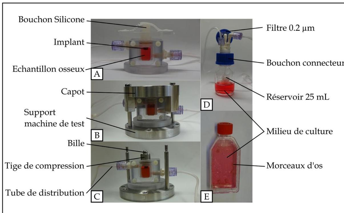
Figure 3.12 Culture osseuse. A. Chambre et échantillon - Configuration  $\mu$ CT. B. Chambre et échantillon - Configuration Culture avec capot. C. Chambre et échantillon - Configuration Culture sans capot. D. Réservoir de milieu de culture. E. Flacon avec morceaux d'os
