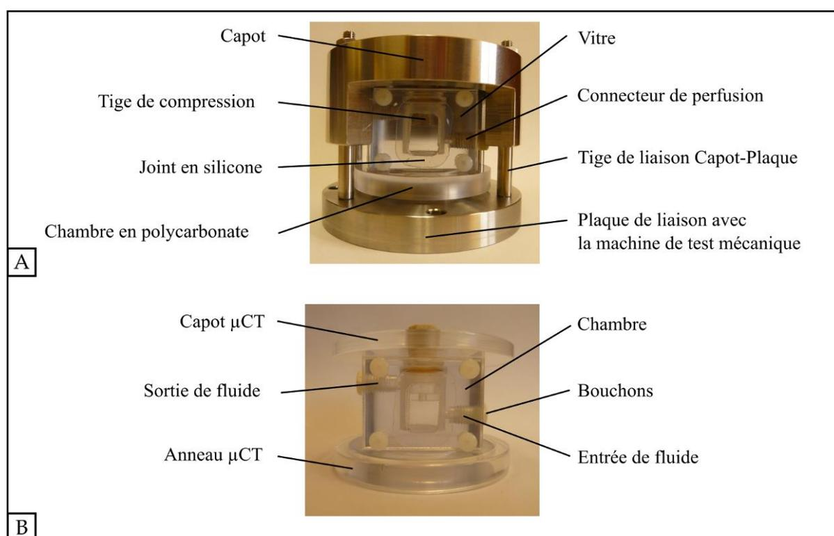
Figure 3.5 Prototype 3 du bioréacteur à perfusion
