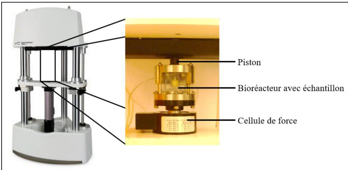
Figure 3.6 Prototype 3 dans la machine de test mécanique
