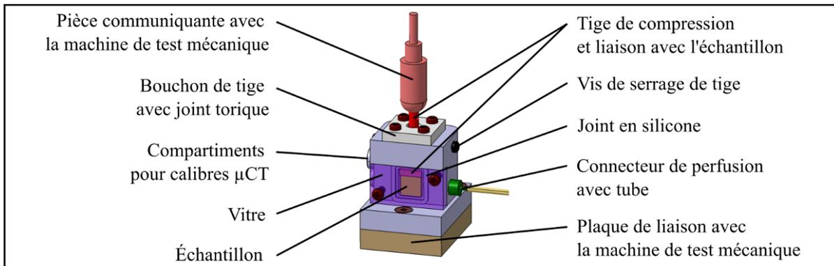
Figure 3.4 Prototype 2 du bioréacteur à perfusion
