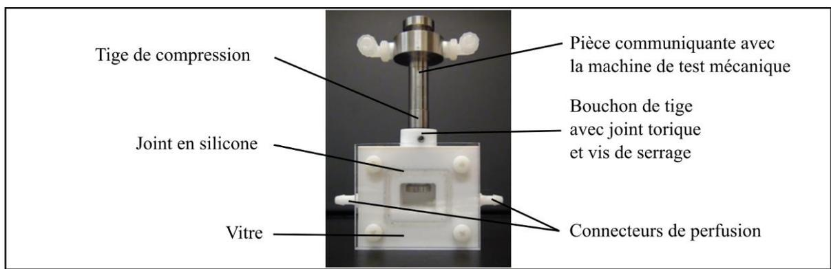
Figure 3.3 Prototype 1 du bioréacteur à perfusion
