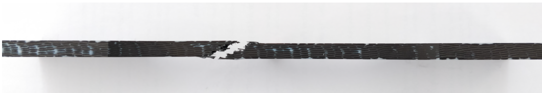
FIGURE D.9 – Photo de l'éprouvette 888-3D208-9-ASN05-TE0-03 rompue en traction-compression
