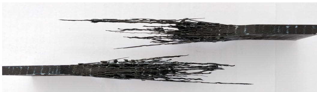
FIGURE D.2 – Photo de l'éprouvette 888-3D208-9-ASN03-TE90-07 rompue en traction-traction
