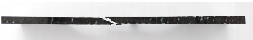
FIGURE D.3 – Photo de l'éprouvette 888-3D208-9-ASN05-TE90-02 rompue en traction-compression
