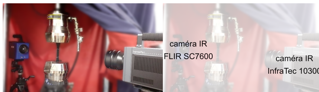
FIGURE B.3 – Dispositif expérimental de l'essai instrumenté avec deux caméras infrarouges.
