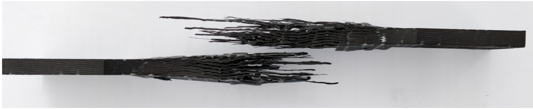
FIGURE D.8 – Photo de l'éprouvette 888-3D208-9-ASN04-TE0-05 rompue en traction-traction
