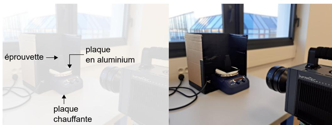
FIGURE 2.13 – Dispositif expérimental mise en place pour l'identification du tenseur de conductivité équivalent.
