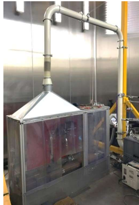
Figure 40: Schéma et photo du banc de soudage utilisé pour la génération et la collecte des particules des Fumées de Soudage (FS)
