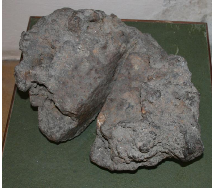
Figure 262 : Exemple de "split bloom", découverte à Sopron (Hongrie) et attribuée au V ème siècle de notre ère (d'après Gömöri, J)
