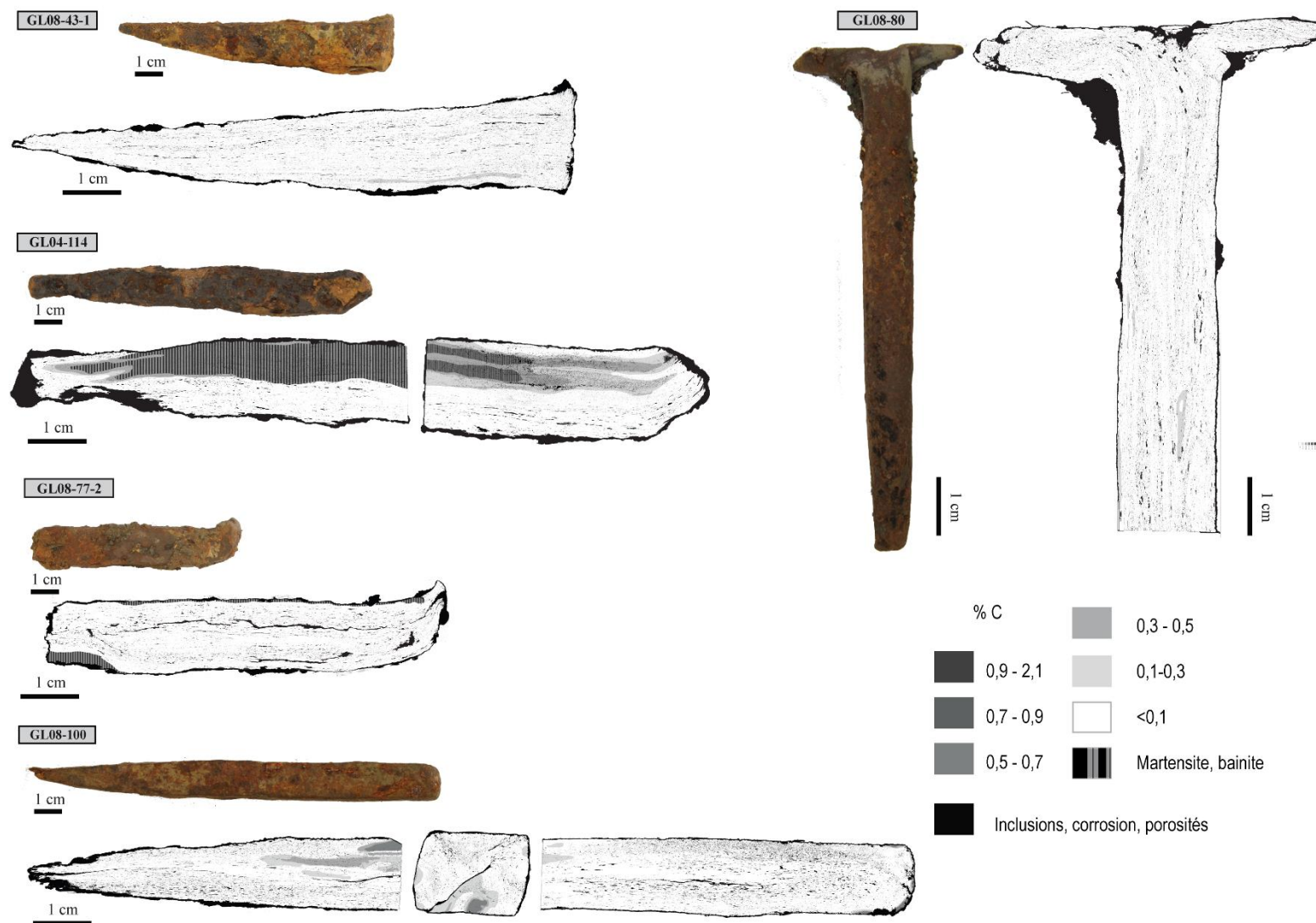
Figure 231 : Caractéristiques métallographiques des fiches de Glinet.
