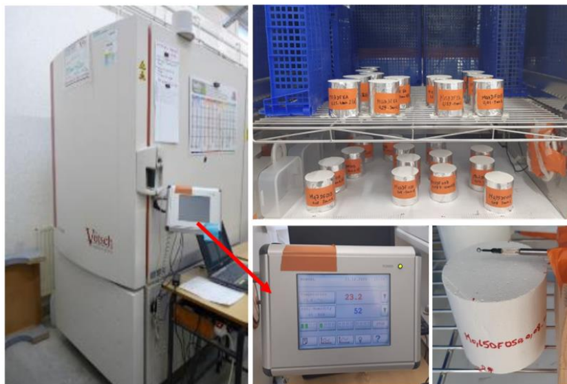
Figure III.5 : Dispositif expérimental pour la mesure de la valeur MBV des mousses minérales.
