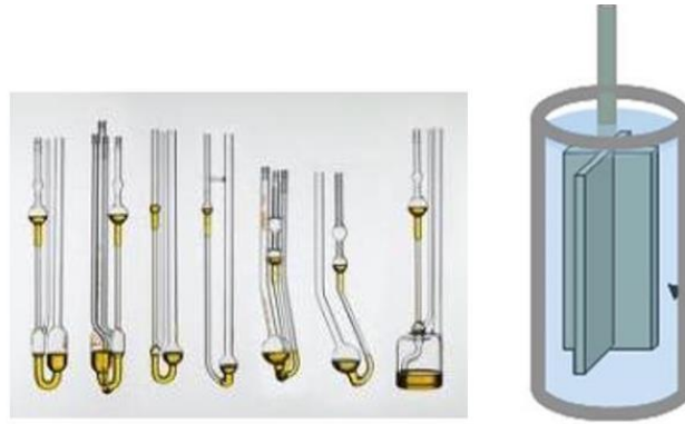
Figure 1.25 : Exemple de rhéomètre capillaire (gauche) [147] et rotatif avec une géométrie vane (droite).
