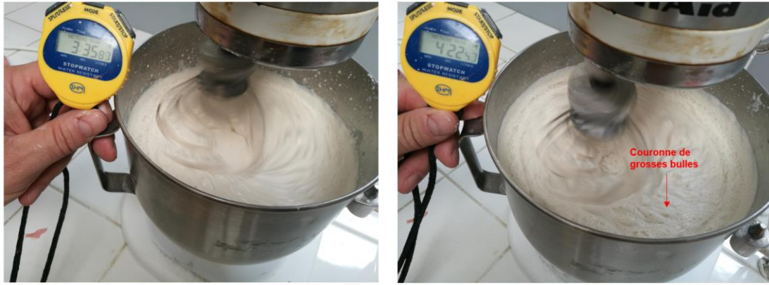
Figure II.38 : Structure à la surface des mousses EA à deux dosages 0,25 % (gauche) et 0,5 % (droite).
