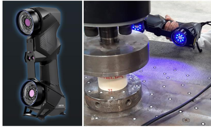
Figure IV.1 : Appareil HandyScan 3D : Les deux caméras du scanner (gauche); Scan d'un échantillon lors d'un essai mécanique (droite).
