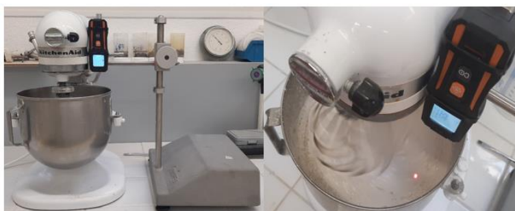
Figure II.5 : Matériel de moussage direct (gauche), mesure de la montée de la mousse pendant le malaxage à l'aide d'un laser (droite).
