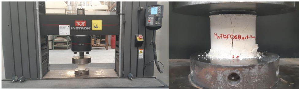
Figure III.6 : Presse Instron® (gauche) ; Essai de compression à l'état final d'un échantillon de mousse de gypse (droite).
