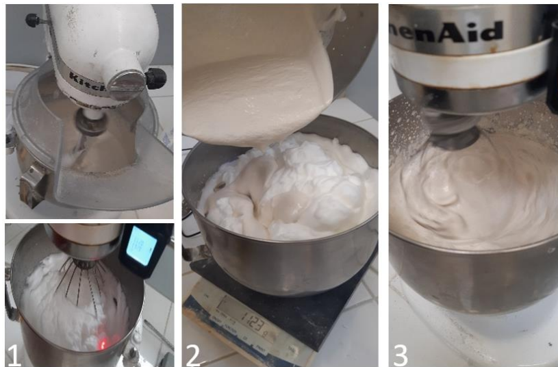
Figure II.6 : Processus de la méthode par pré-moussage : 1) La pâte est préparée séparément de la mousse aqueuse. 2) La pâte est ajoutée doucement à la mousse aqueuse. 3) Malaxage des composants afin d'avoir une mousse homogène.
