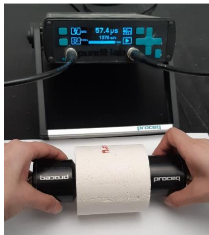
Figure III.10 : Appareil Pundit® pour la mesure acoustique : mesure du temps de propagation des ultrasons dans l'échantillon.
