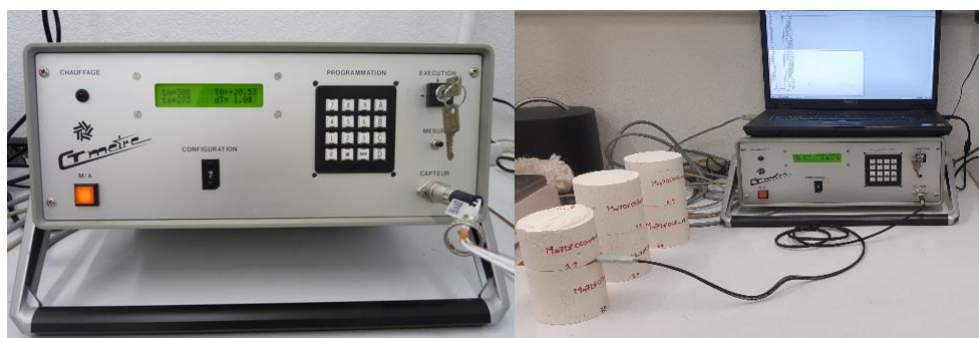
Figure III.1 : Dispositif de mesure : Appareil CT-mètre (gauche), mesure de la conductivité des mousses de gypse à l'état humide (droite).
