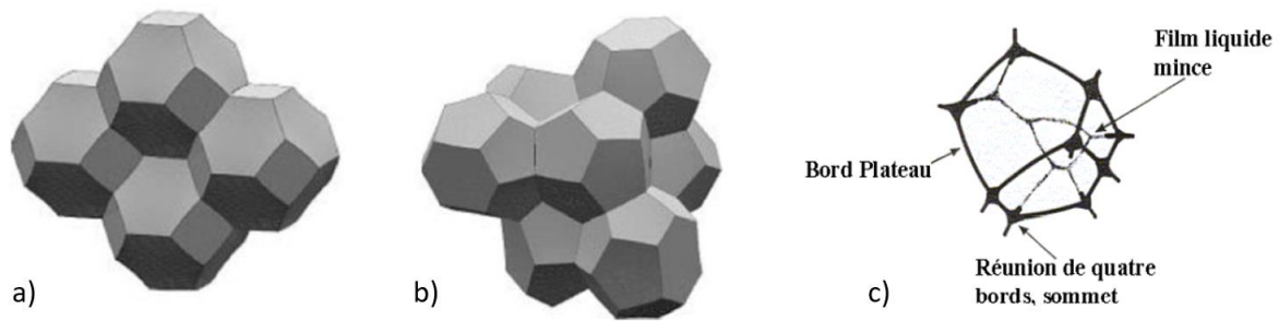
Figure I.19 : a) Empilement tétrakaidécaèdre de Kelvin. b) Empilement de Wheaire et Phelan. c) Géométrie de Plateau-Gibbs [136].
